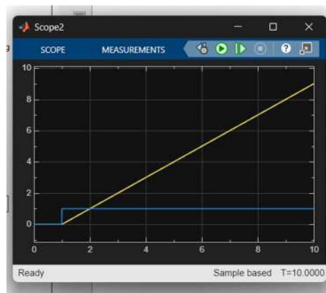
Rysunek 6 - model 4 - odpowiedź układu na skok jednostkowy
